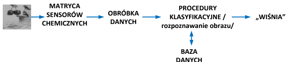
Rysunek 1. Schemat działania sztucznego zmysłu smaku
